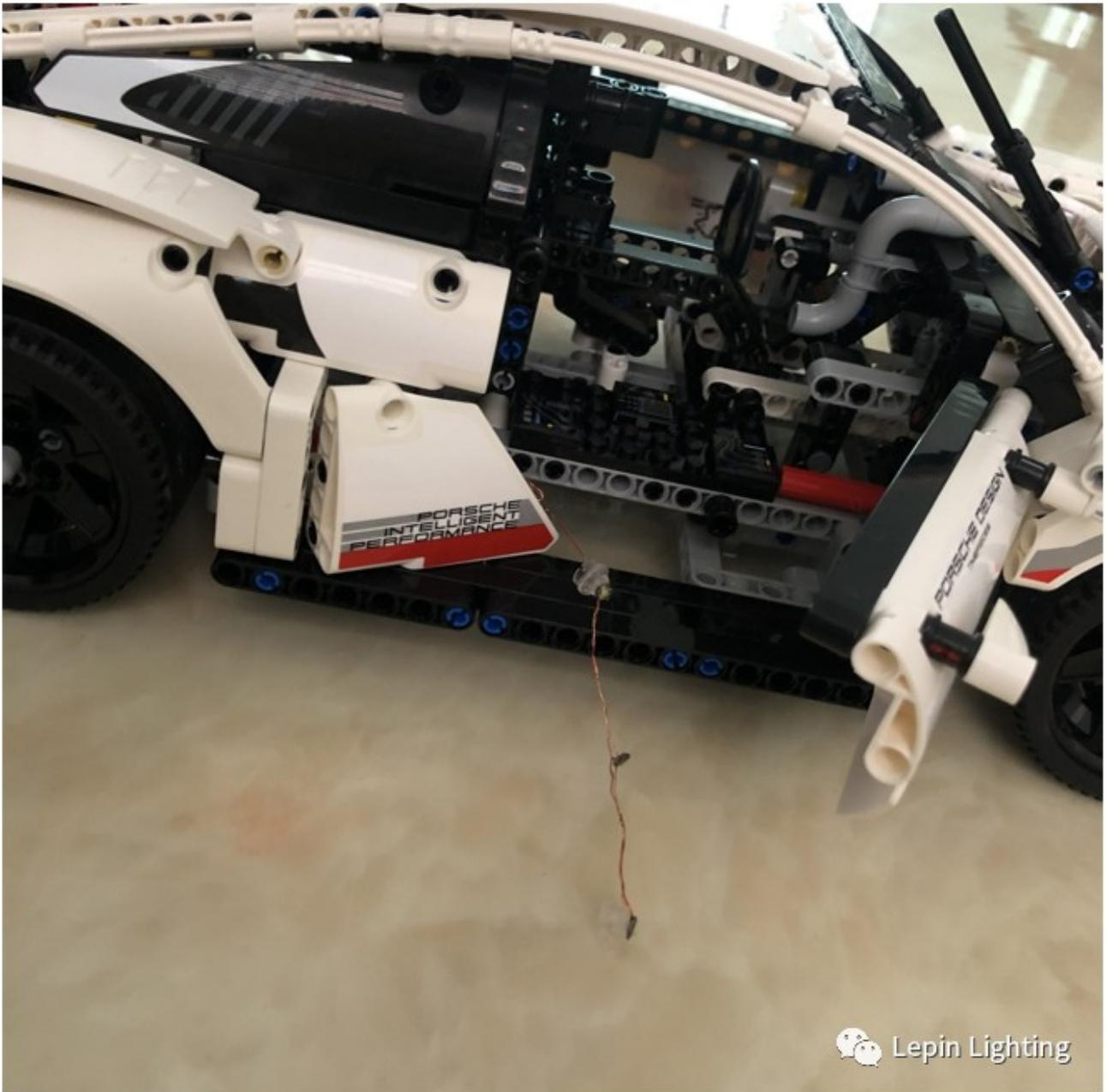
5. Entfernen Sie die roten Teile an der Vorderseite des Fahrzeugs, um die Linie zu verbergen, und installieren Sie dann die 8 kleinen Lichter an den auf den Bildern angegebenen Stellen. Stellen Sie nach dem Einbau die roten Teile wieder her
